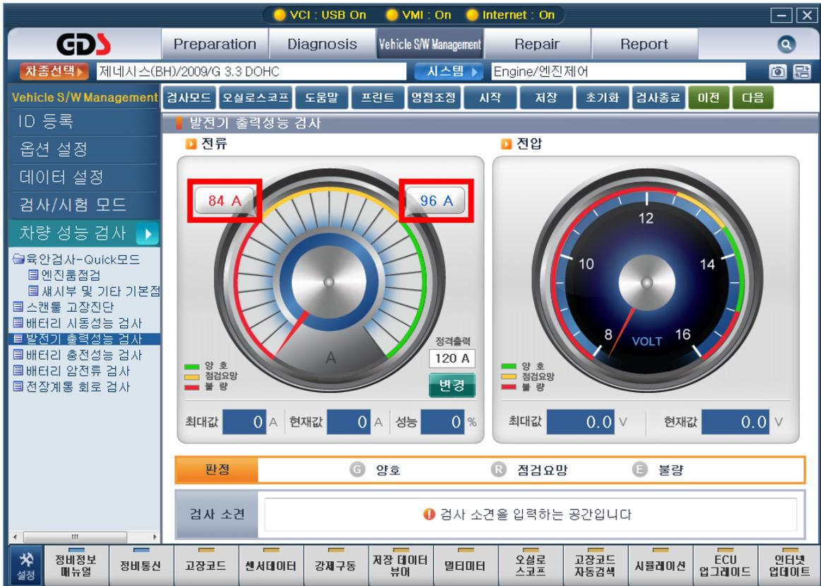
[그림 24] 발전기 정격출력 용량의 양부판정 값 표시 화면
