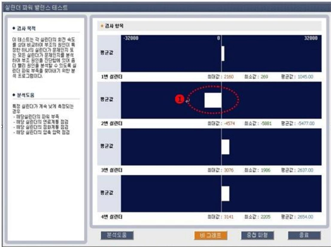
[그림 13] 실린더 파워밸런스 테스트 화면
