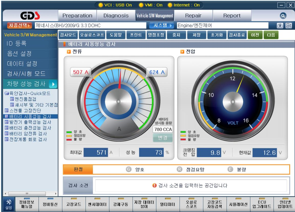
[그림 20] 배터리 시동성능 검사 결과
