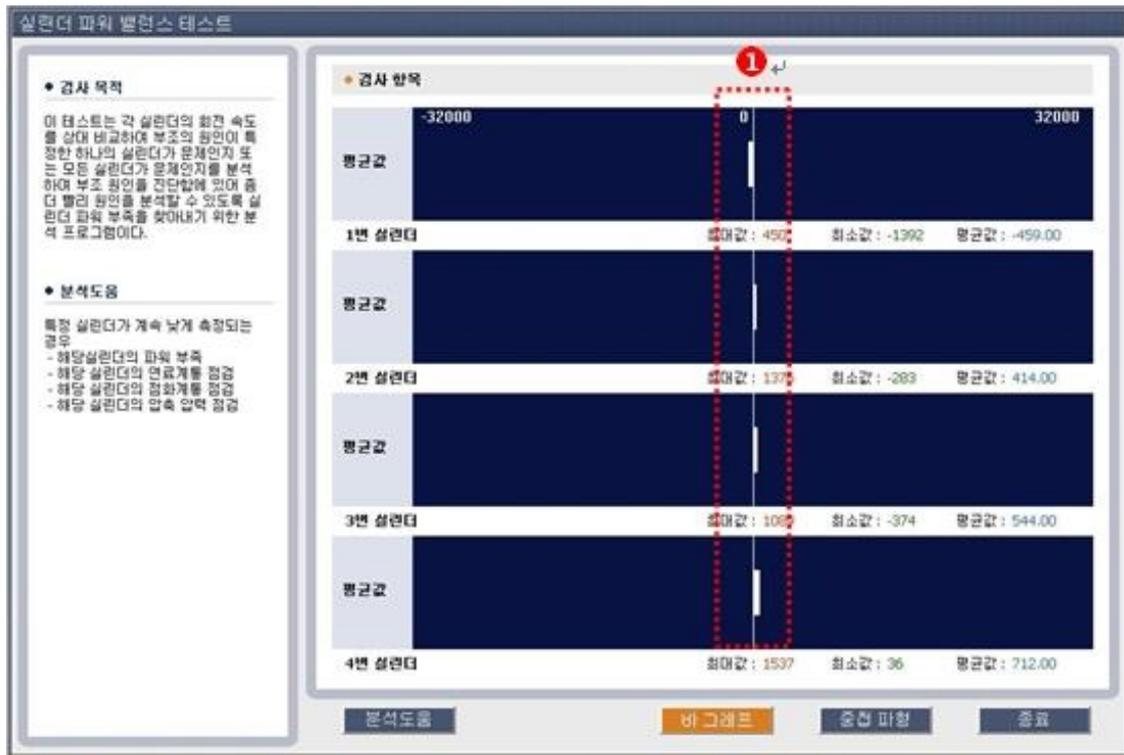
[그림 14] 실린더 파워밸런스 테스트 - 정상시
