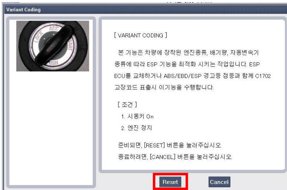
[그림 3] 옵션설정\_ Variant Coding 기능 실행화면
