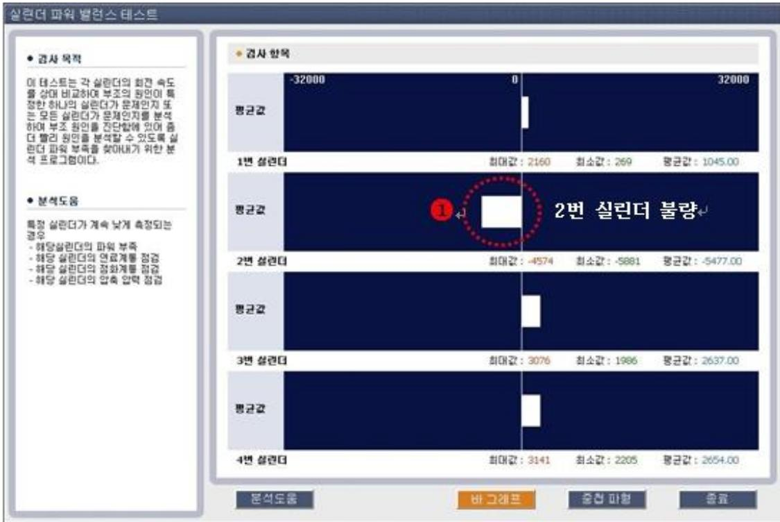
[그림 15] 실린더 파워밸런스 테스트 - 1개 실린더 불량시
