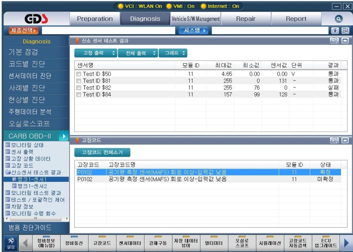
[그림 7] 산소센서 테스트 결과
