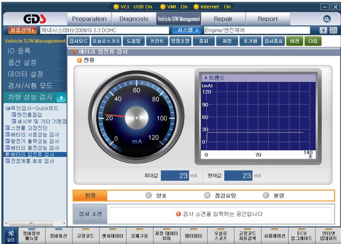
[그림 27] 배터리 암전류 검사
