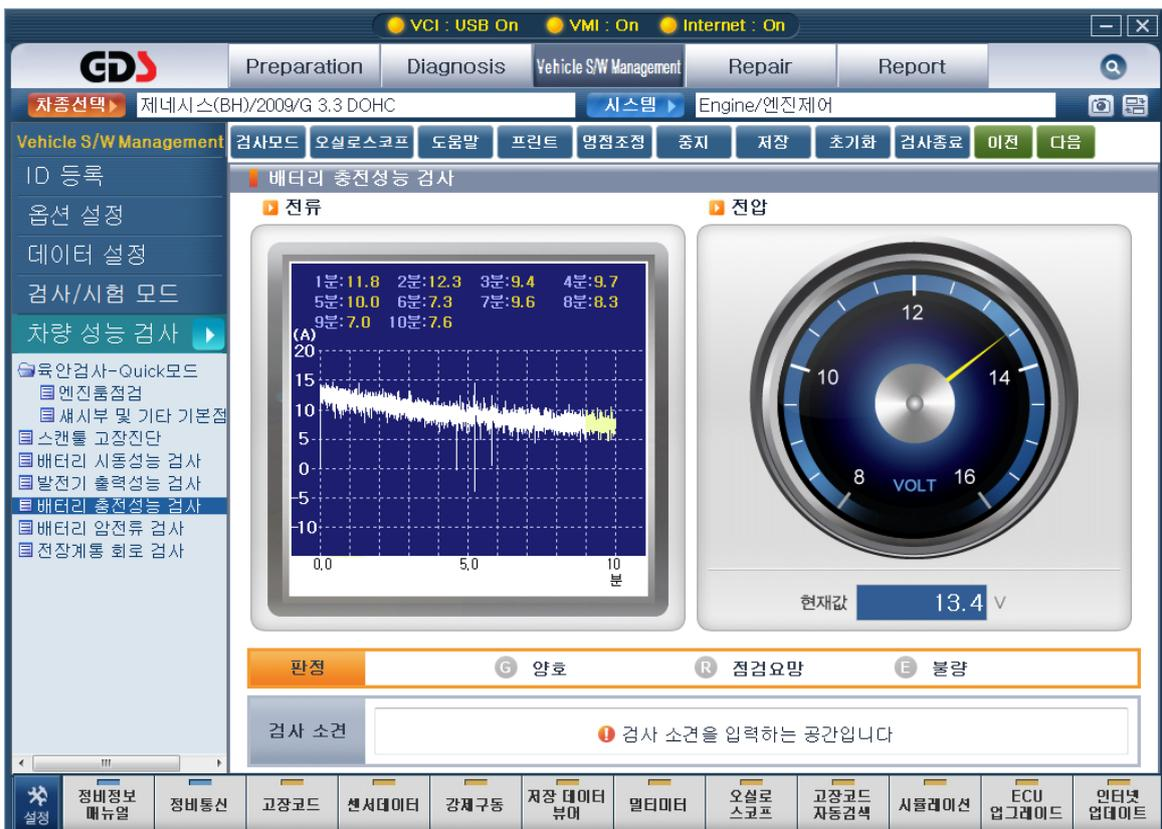
[그림 26] 배터리 충전성능 검사 결과
