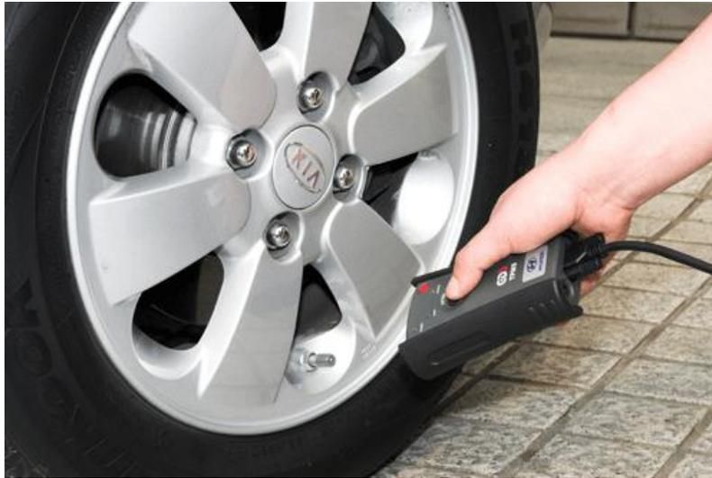
[그림 4] TPMS 센서 정보(무선) 측정
