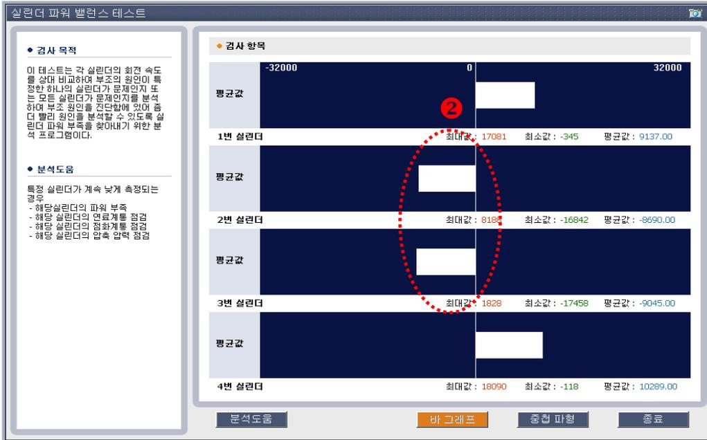
[그림 16] 실린더 파워밸런스 테스트 - 2개 실린더 불량시
