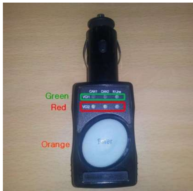
그림 3-8 콤팩트 VCI 용 트리거 모듈 LED
