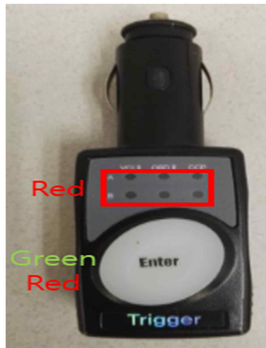
그림 3-10 VCI-II 용 트리거 모듈 LED
